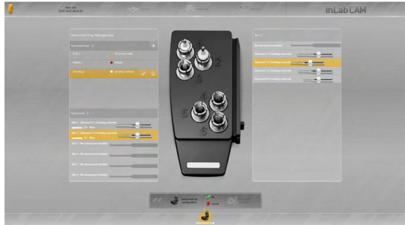
1. Klicken Sie auf den Steckplatz in der Liste links oder auf die eine Position auf dem dargestellten Instrumentenhalter, um ein Instrument an einer bestimmten Stelle einzusetzen.
