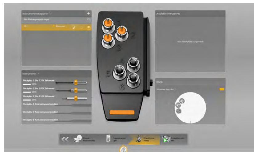
↳ Alle Informationen werden angezeigt. Es können nun alle Werkzeugmagazine angezeigt werden, es können diese getauscht oder Werkzeuge in diesem ersetzt werden. Wenn Änderungen am Magazin in der Maschine getätigt werden, sind diese an der Maschine zu bestätigen.
